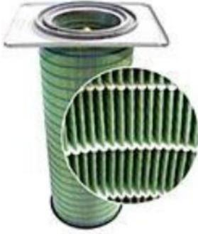
El corazón del equipo son sus filtros primarios cilíndricos de última generación **CASIBA 4710-CAR-STXL**, construidos a partir de una hoja continua de medio filtrante plisado no tejido, compuesto por fibras sintéticas de poliéster y fibras de celulosa tratada químicamente.
