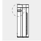
13. Los dos arcos a ambos lados del panel de operación no son asas y no se debe tirar de ellos. Las manijas para el transporte del equipo se encuentran en ambos laterales del cuerpo del purificador, como se indica en el gráfico.
